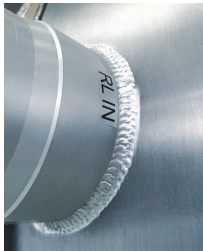
均匀饱满、成型美观的鱼鳞焊缝
